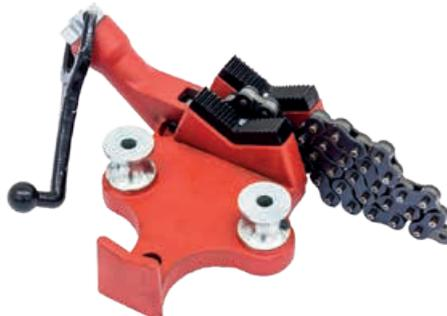
Цепные тиски предназначены для надежной фиксации трубных конструкций, диаметром до 170 мм. Тиски характеризуются максимально надежным захватом трубных конструкций, происходящим посредством поворота зажимного винта. Изогнутая зажимная рукоятка крепится к корпусу. На крепком чугунном корпусе находятся губки из закаленной легированной стали, удобная опора для труб и гибочный ролик.
